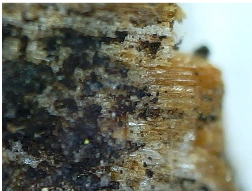
Fot.1. Zdjęcie mikroskopowe powierzchni próbki drewna nr. 3 pobranej z elewacji ściany wschodniej kościoła pw. Narodzenia NMP w Krzeszowie. Widoczne kryształy impregnatu wytrącone na powierzchni drewna oraz czarny nalot. Fot. Barbara Sowa-Holewińska. 2022
